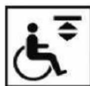
Slika 1.11.: Oznaka pristupačne vertikalne podizne platforme
