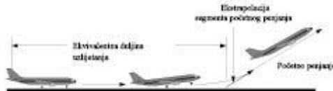
Slika B-1: Ekvivalentna duljina uzljetanja
