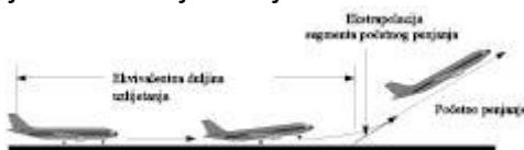
Slika B-1: Ekvivalentna duljina uzljetanja
