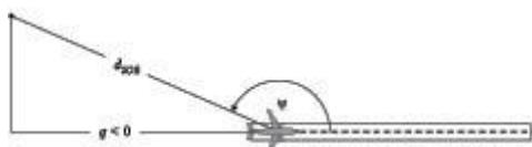
Slika 2.7.r: Geometrija zrakoplova i promatrača na tlu radi procjene korekcije za usmjerenoost
