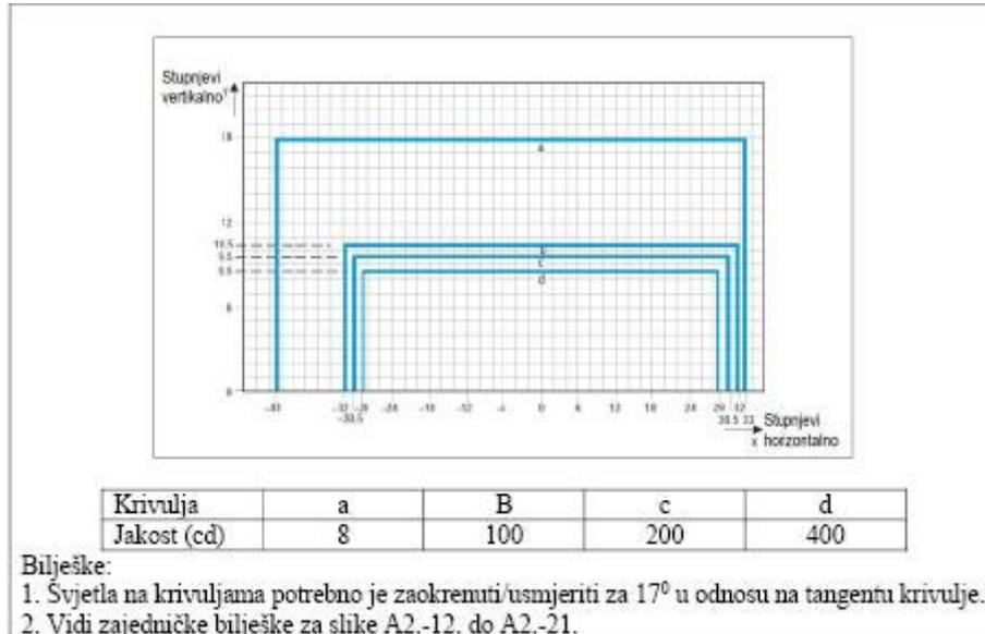
Slika A2-19. Dijagram izokandela za svjetla središnje crte staze za vožnju velike jakosti (razmak 7.5 m), svjetla prečke zabrane ulaza i svjetla stop-prečke u zakrivljenim sekcijama namijenjena korištenju u naprednom sustavu za navođenje i kontrolu površinskog kretanja u slučajevima kada su potrebna svjetla veće jakosti
