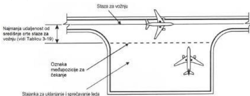
Slika 3-4. Najmanja sigurnosna udaljenost površine za odleđivanje zrakoplova
