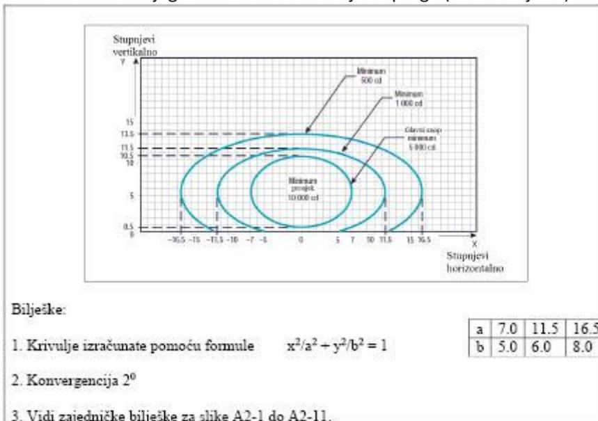
Slika A2-4. Dijagram izokandela za svjetlo praga krilne prečke (zeleno svjetlo)
