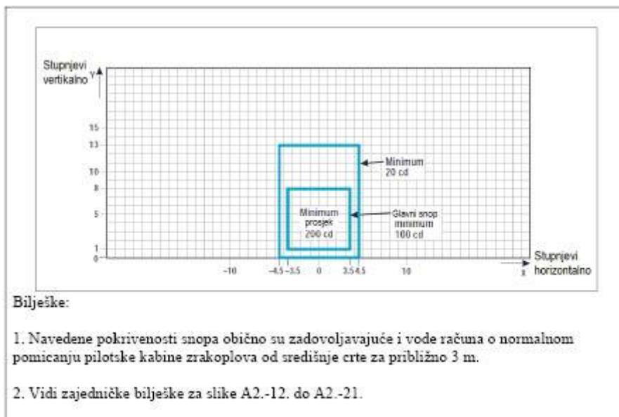
Slika A2-13. Dijagram izokandela za svjetla središnje crte staze za vožnju (razmak 15 m), svjetla prečke zabrane ulaza i svjetla stop-prečke u ravnim sekcijama namijenjena korištenju u uvjetima kad je vidljivost manja od 350 m
