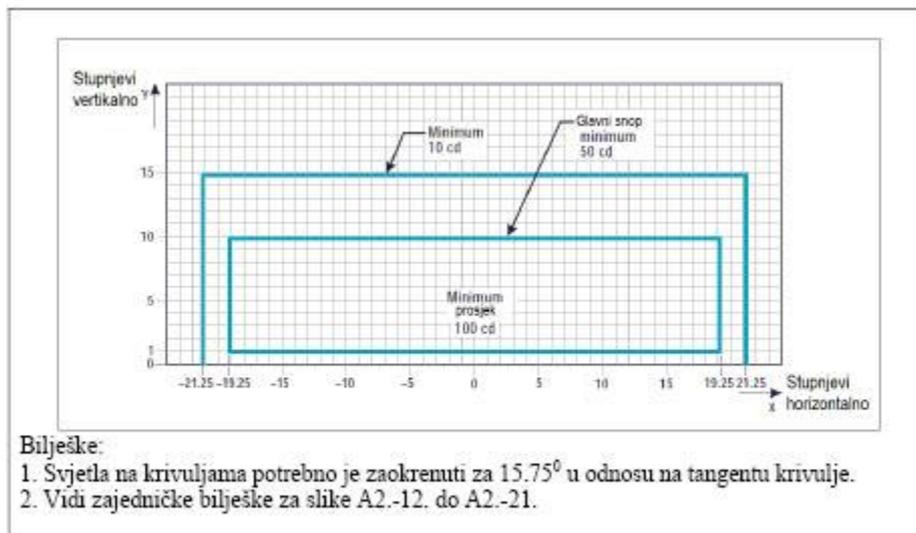
Slika A2-14. Dijagram izokandela za svjetla središnje crte staze za vožnju (razmak 7.5 m), svjetla prečke zabrane ulaza i svjetla stop-prečke u zakrivljenim sekcijama namijenjena korištenju u uvjetima kad je vidljivost manja od 350 m
