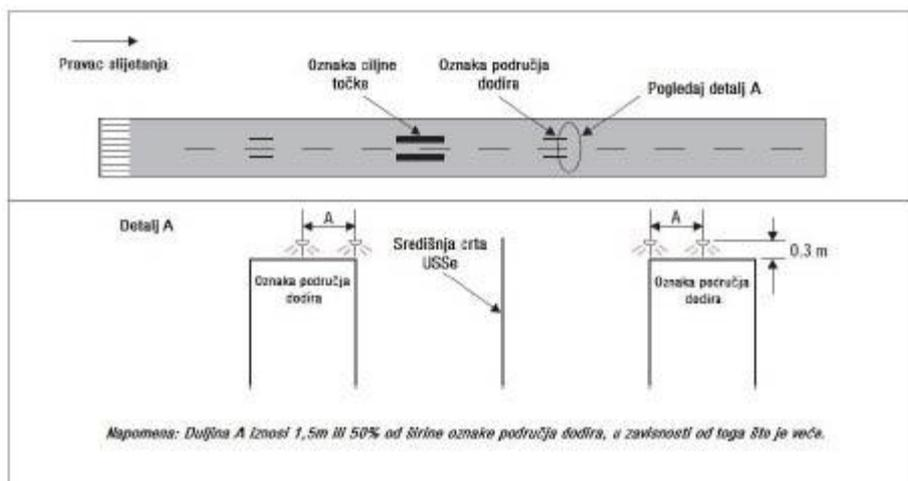
Slika 5-20. Primjer postavljenog jednostavnog sustava svjetala područja dodira
