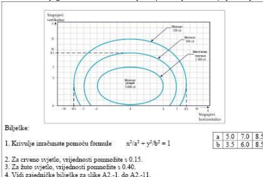
Slika A2-6. Dijagram izokandela za svjetlo središnje crte USSe longitudinalnog razmaka 30 m (bijelo svjetlo) i kratkog svjetla pokazatelja izlazne rulne staze (žuto svjetlo)
