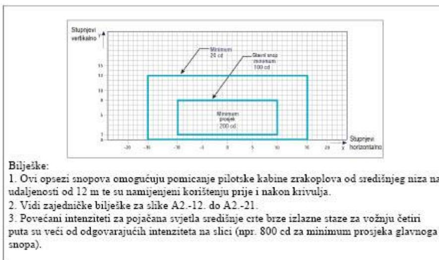
Slika A2-12. Dijagram izokandela za svjetla središnje crte staze za vožnju (razmak 15 m), svjetla prečke zabrane ulaza i svjetla stop-prečke u ravnim sekcijama namijenjena korištenju u uvjetima kad je vidljivost manja od 350 m, kada može doći do velikih suprotnih djelovanja i za sigurnosna svjetla uzletno-sletne staze slabe jakosti, konfiguracija B
