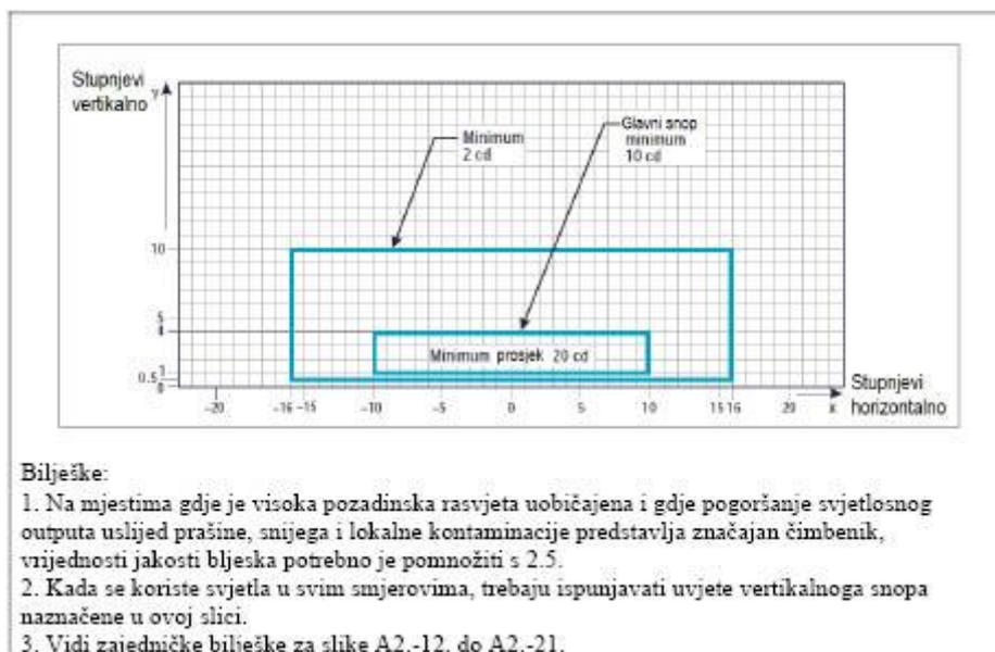
Slika A2-15. Dijagram izokandela za svjetla središnje crte staze za vožnju (razmak 30 m, 60 m ), svjetla prečke zabrane ulaza i svjetla stop-prečke u ravnim sekcijama namijenjena korištenju u uvjetima kad je vidljivost minimalno 350 m
