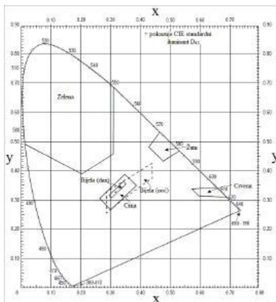
Slika A1-4. Boje svjetlećih ili transluminiranih (iznutra osvjetljenih) znakova i ploča
