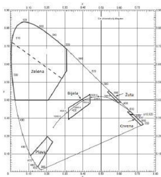
Slika A1-1b. Boje za LED aeronautička svjetla na tlu
