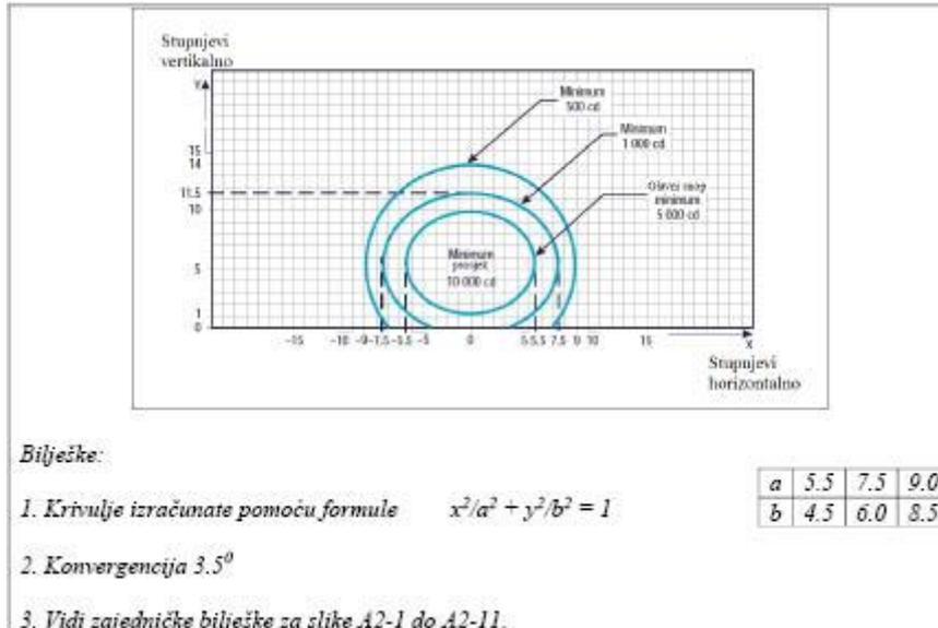
Slika A2-3. Dijagram izokandela za svjetlo praga (zeleno svjetlo)
