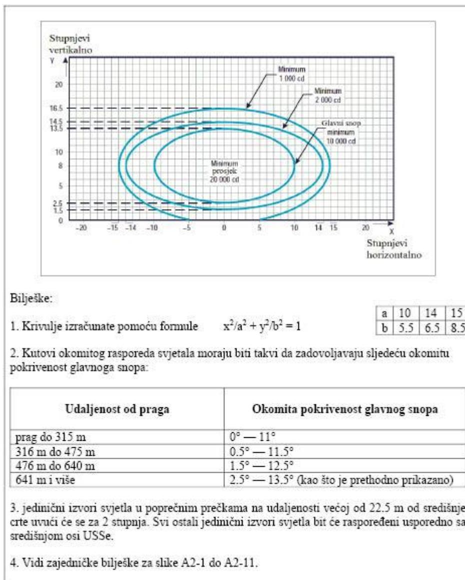
Slika A2-1. Dijagram izokandela za svjetlo produžene središnje crte sustava prilazne rasvjete i poprečne prečke (bijelo svjetlo)
