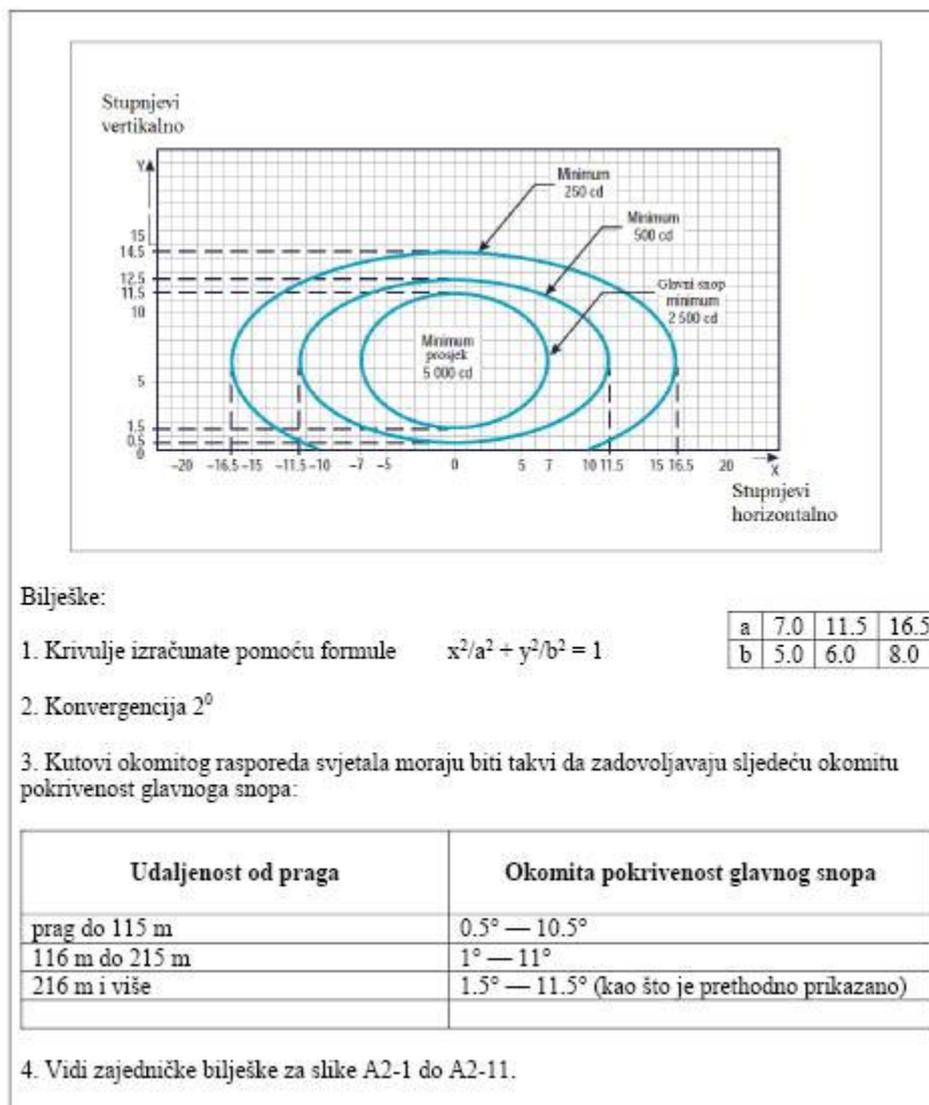
Slika A2-2. Dijagram izokandela za svjetla bočnog reda sustava prilazne rasvjete (crveno svjetlo)
